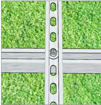
Des vis de fondations placées directement dans la terre. Une structure parfaitement plane sur un sol en pente et bosselé.
