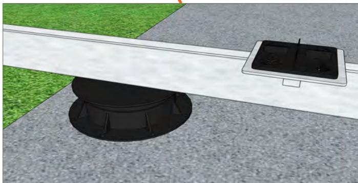
Une stabilité accrue grâce à la fixation de la structure sur les plots.
