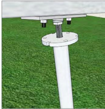
Un système de fixation mural articulé pour une structure parfaitement horizontale.
