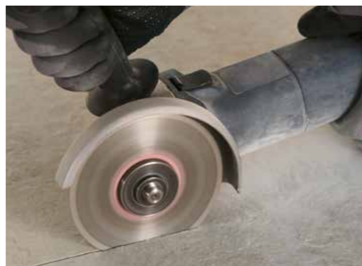
Disqueuse à sec. Disque à jante continue destiné à la découpe de carrelage.
